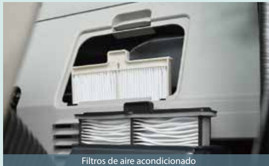
Filtros de aire acondicionado
